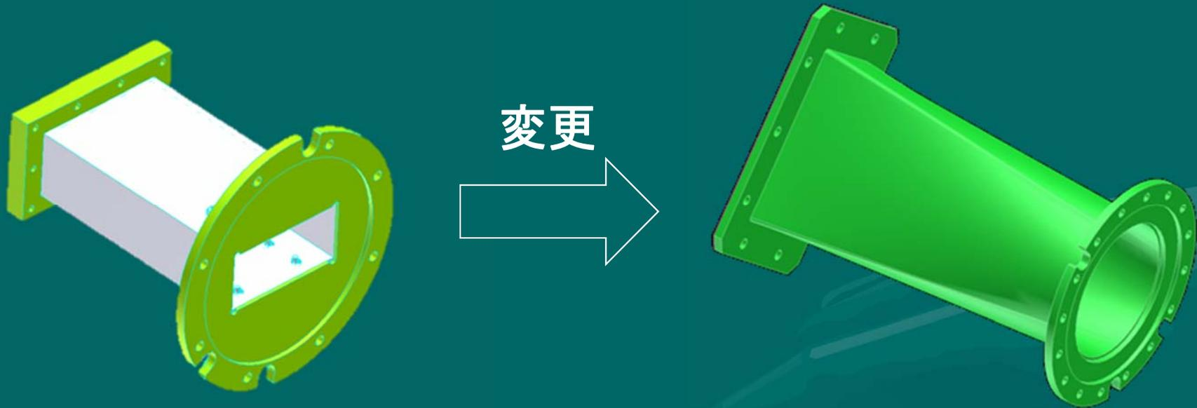
共振によるマッチングではなく、できるだけ低反射となるよう導波管断面が徐々にプラズマチャンバー形状に変わるように変更。
