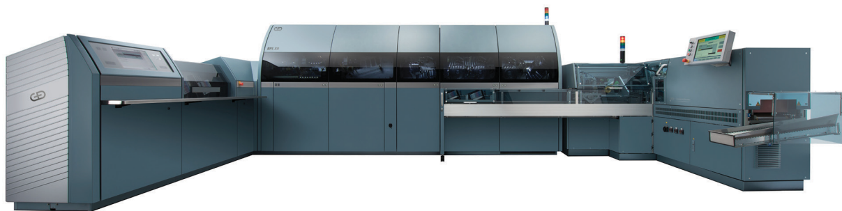
图 1. BPS X9 是世界上最快的纸币处理系统,每秒可处理 44 张纸币,每小时的有效吞吐量超过 15 万张。中央模块的尺寸为 1.9 米高,5.7 米宽。
