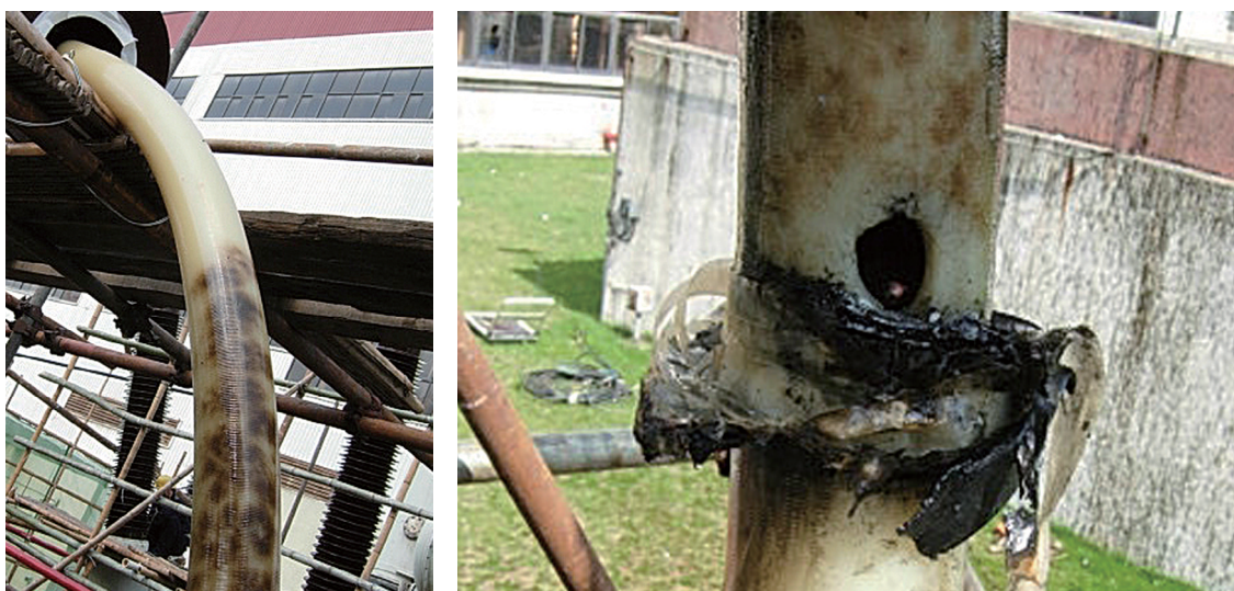
图 2. 左：电缆绝缘层在水分和电场同时作用下而产生的水树现象；右：绝缘层的机械损伤。
