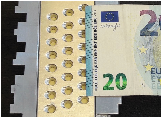
图 4. 由 24 个发射器组成的阵列可以发射通过纸币的超声信号。插图 为 20 欧元的纸币。
