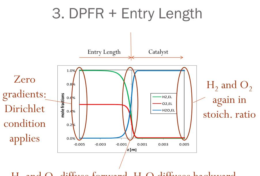
$H_2$  and  $O_2$  diffuse forward,  $H_2O$  diffuses backward
